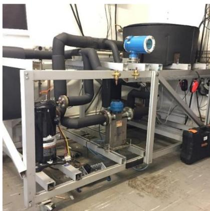
Figura 1. Bancada experimental de refrigeração utilizada
